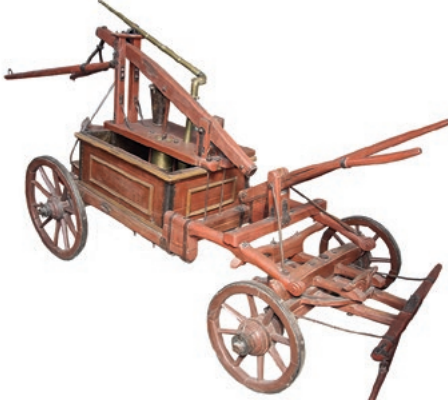
Fahrbare Handdruckspritze von 1624 mit Wenderohr Deutsches Feuerwehrmuseum Fulda
