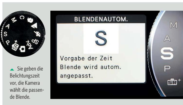
stellen Sie mit dem kleinen Drehrad auf der Kamerarückseite ein. Der Wert wird am unteren Rand des Bildschirms angezeigt mit Werten zwischen 4000 = 1/4000 Sekunde und 30 = 30 Sekunden. Wie im Programm P können Sie mit dem oberen Drehrad eine Belichtungskorrektur einstellen.
