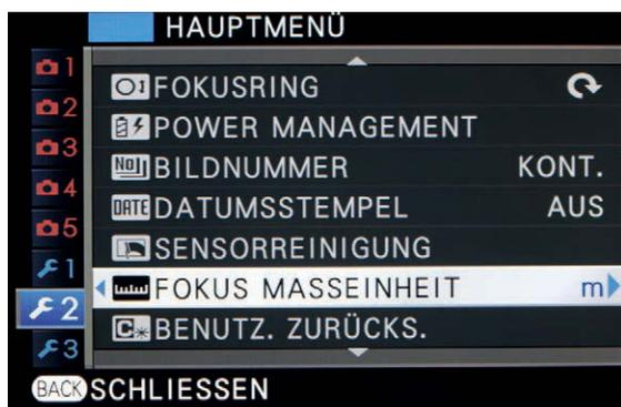
◀ Stellen Sie hier ein, ob die Entfernung beim manuellen Fokussieren in Metern oder Fuß angezeigt werden soll.
