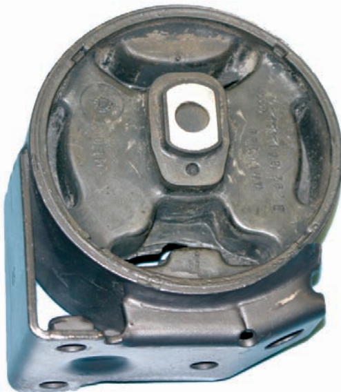
Bild 2-1. Motorlager eines Volkswagen Golf II, Baujahr 1985.
