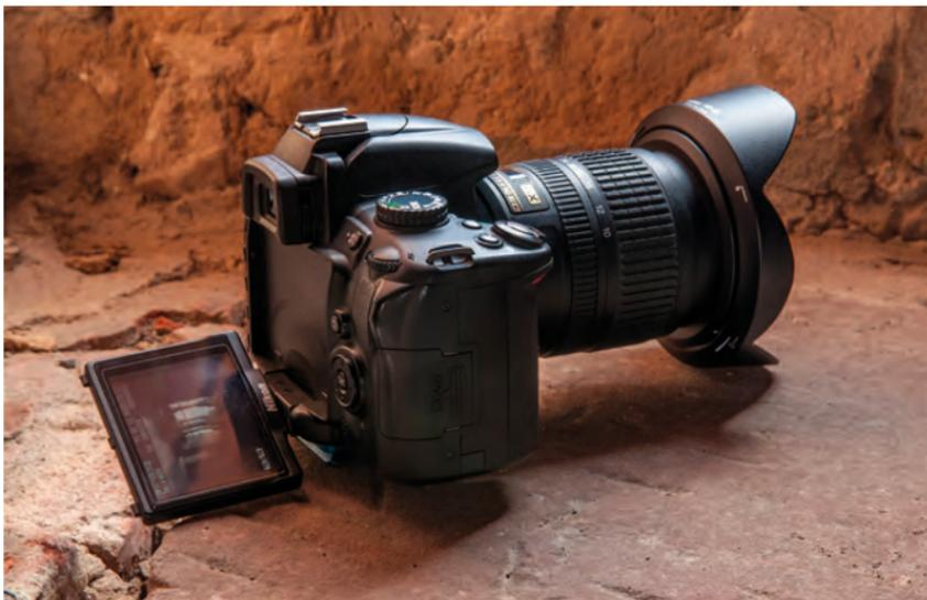
Meine Allzweckwaffe im Urbex-Einsatz: eine ganz normale digitale Amateurspiegelreflexkamera mit schwenkbarem Monitor, 12,3 Megapixeln Auflösung und angesetztem 10-24-mm-Objektiv.
