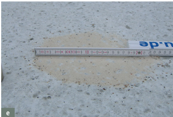
Bild 2.16 (Fortsetzung): Fertigteilplatten von Elementwänden mit unterschiedlicher Rauigkeit: (c) R_t = 1,6 mm, (d) R_t = 0,9 mm, (e) R_t = 0,6 mm
