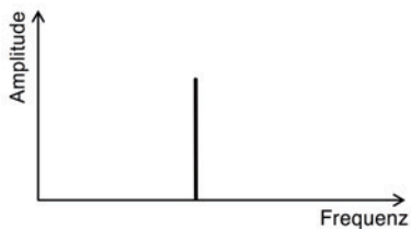
Abb. 1.15: Amplituden-Frequenz-Diagramm (Spektrum einer Sinusschwingung).
