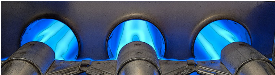
Verbrennungsdüsen eines Gasbrenners, Quelle: fotolia
