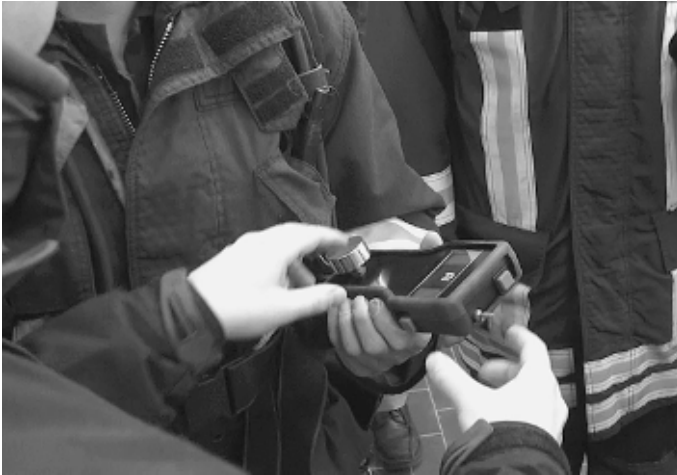
Abb. 6: Eingabegerät für das Auslesen und Umprogrammieren der LANDMARKEN der ‚Entwicklungsstufe 4‘
