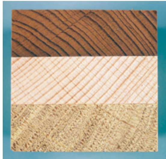
Abb. 2.5: Kombinierte Holzkanzel mit Außenlagen aus thermisch behandelter Buche (oben) und unbehandelter Eiche (unten) und Innenlage aus unbehandelter Buche (Mitte)
