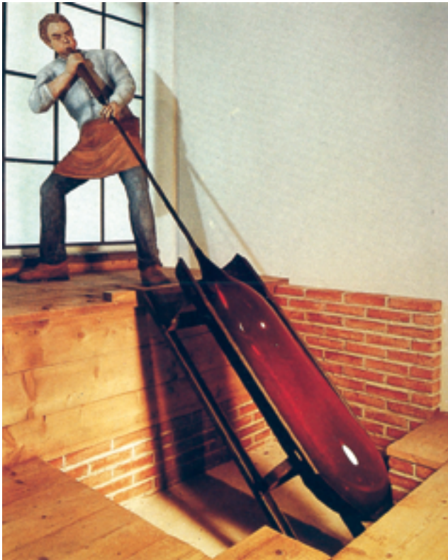
Abb. 1.45: Fensterscheibenherstellung aus einem Glaszylinder im Zylinderblas- und -streckverfahren (Quelle: Glocker, 1992, S. 79)
