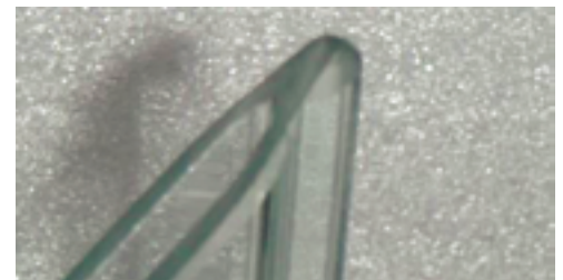
Abb. 1.51: Isoliergläser wurden am Rand gelötet, geklebt oder – wie hier gezeigt – verschweißt. Durchgesetzt hat sich das geklebte Isolierglas. (Quelle: Geschichte des Glases, 2004)
