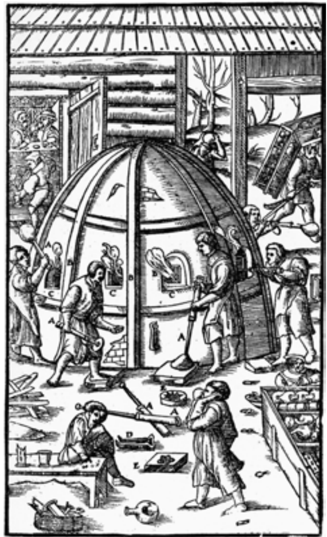
Abb. 1.44: Darstellung eines mittelalterlichen Glasschmelzofens aus Georgius Agricolus „De re metallica“, 1556, mit einer bienenwabentartigen Form und 3 Räumen, dem Feuerungs-, Schmelz- und Kühlraum (Quelle: Glocker, 1992, S. 17)
