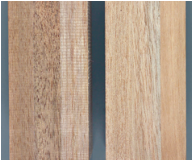
Abb. 2.4: Beispiele für schichtverleimte Kanteln aus jeweils verschiedenen tropischen Hölzern (sogenannte „Mixed Tropical Species“), die in vielen Fällen als „Dark Red Meranti“ deklariert werden
