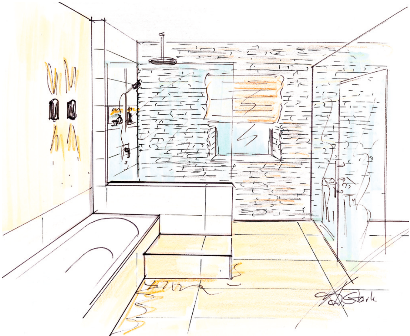
Abb. 1.21: Die durchgehende Bruchsteinwand an der Kopfseite verkürzt die Langstreckung des Raums.
