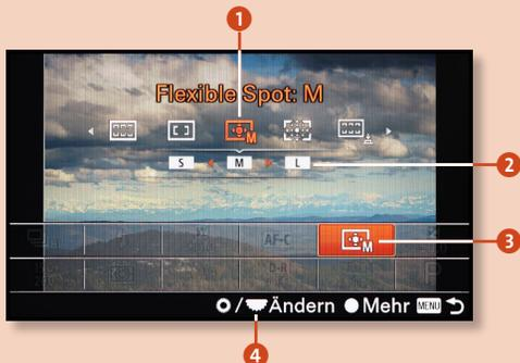
bieten, wie hier die Feldgrößen **S**, **M** oder **L** **2**, verwenden Sie den Drehregler **⦿**, um Ihre Auswahl zu treffen. Die benötigten Steuerelemente zur Navigation im Menü werden Ihnen übrigens am unteren Monitorrand stets mit angezeigt **4**.
