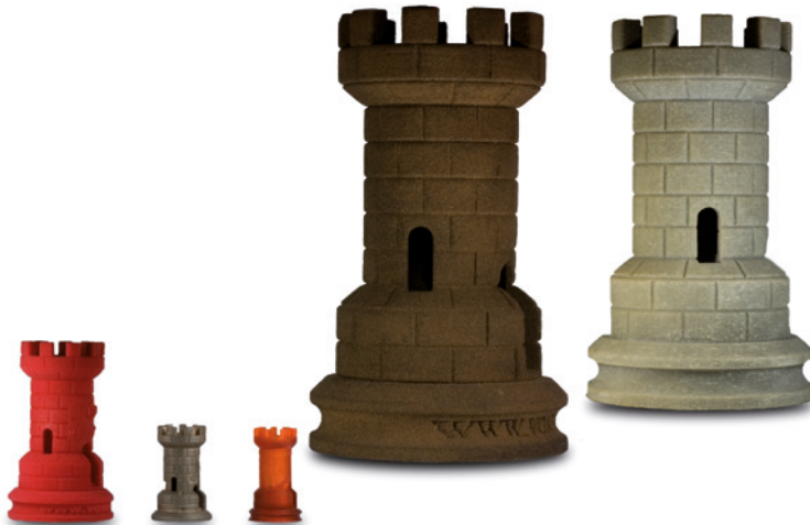
Bild 1.2 Additive Fertigung. Aus dem gleichen Datensatz abgeleitete, aber mit unterschiedlichen Verfahren hergestellte Türme.
