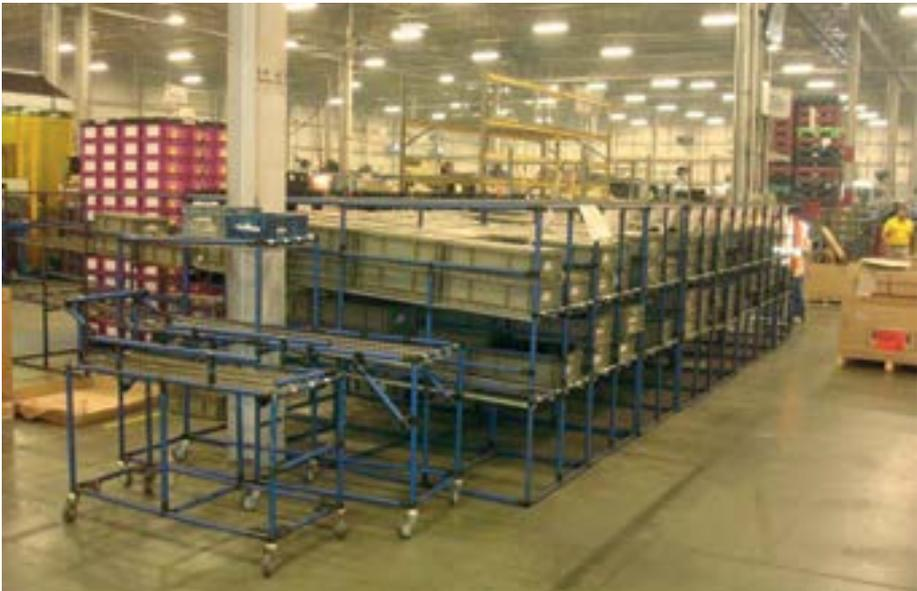
**Bild 1.12** Puffer zwischen Vormontage und Endmontage
