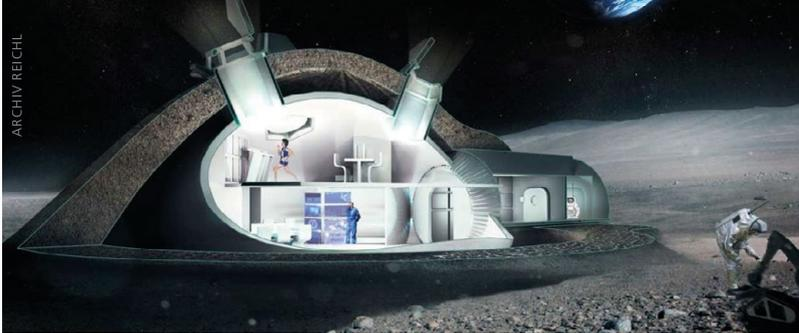
Die Habitate müssen mit einer Schicht aus lunarem Regolith vor der Strahlung geschützt werden. Diese Schicht muss zwei bis drei Meter dick sein.
