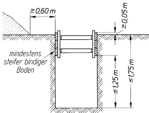
Bild 4 (nach DIN 4124): Teilweise verbauter Graben
