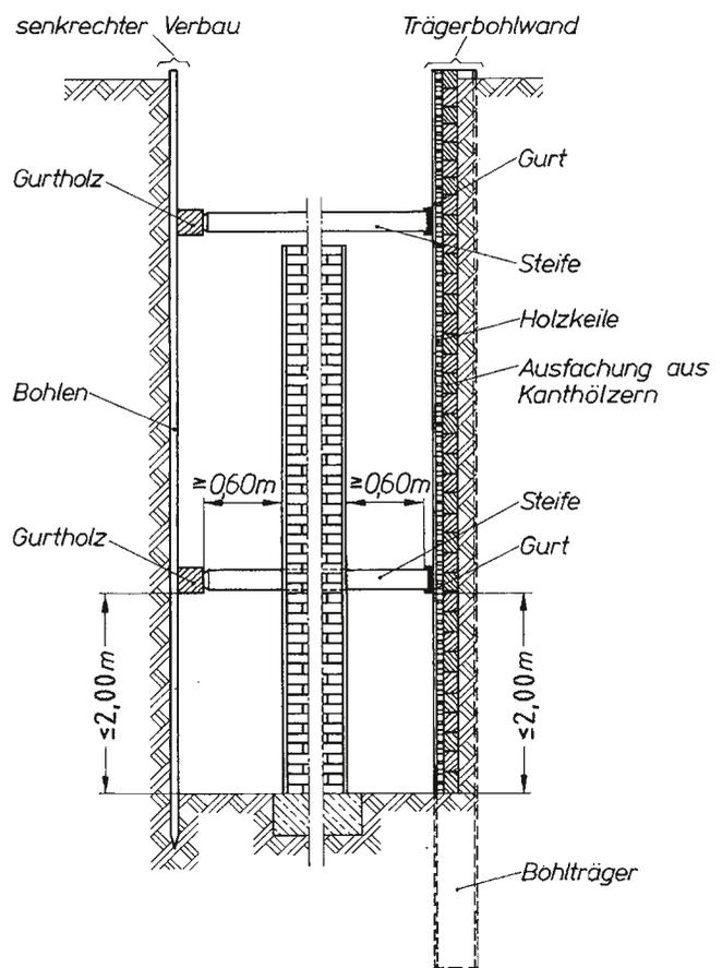
Bild 19 (nach DIN 4124): Arbeitsraum bei verbauten Baugruben mit Behinderung durch Gurte und Steifen (Beispiel)
