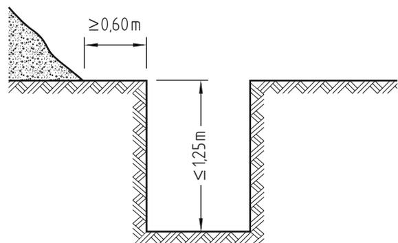
Bild 2 (nach DIN 4124): Graben mit senkrechten Wänden
