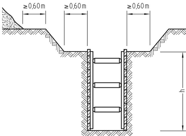
Bild 1 (nach DIN 4124): Verbauter Graben mit geböschtem Voraushub
