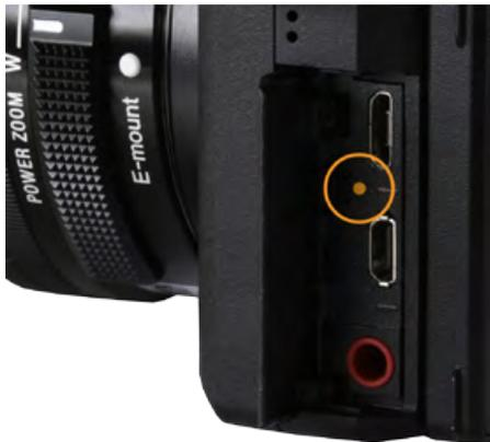
◀ Die orangefarbene Markierung zeigt den HDMI- und den Micro-USB-Anschluss, die Note die Kontrolllampe. Solange die Kontrolllampe leuchtet, wird der Akku aufgeladen.
