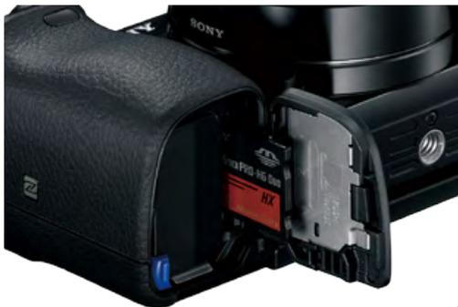
▼ Im oberen Bild wird ein Memory Stick Pro Duo eingelegt, im unteren Bild eine SD-Speicherkarte. Beide verwenden denselben Speicherkartenschacht.
