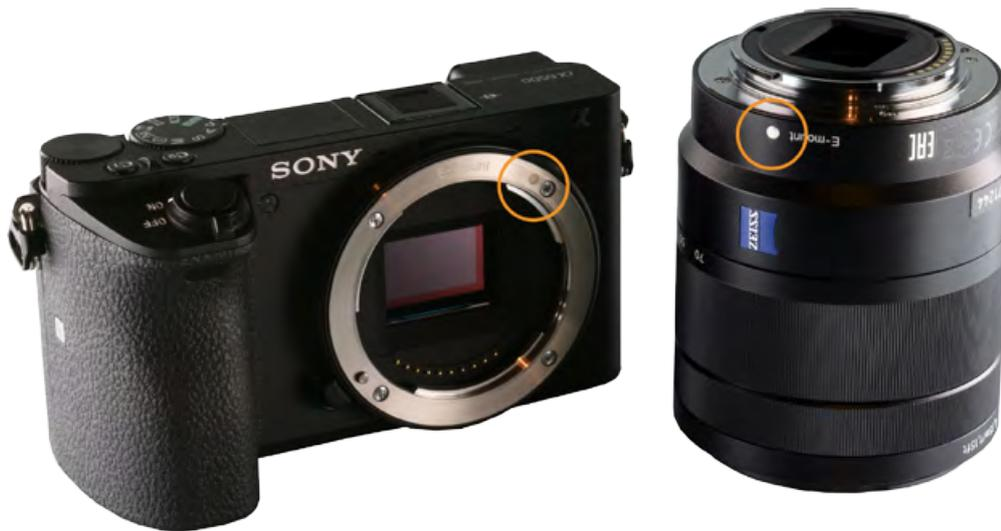
▲ An den in den Bildern markierten Markierungspunkten erkennen Sie, wie das Objektiv angesetzt werden muss.
