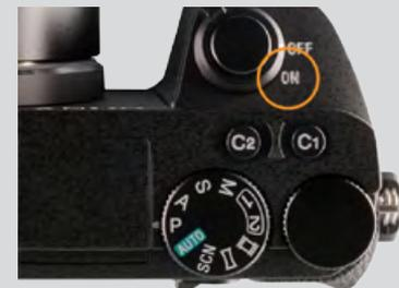
▲ Mit der hervorgehobenen Einstellung ist die Kamera eingeschaltet. Unter dem ON/OFF-Schalter sehen Sie das Moduswahlrad, mit dem Sie unter anderem die gewünschte Belichtungsmessart einstellen.
