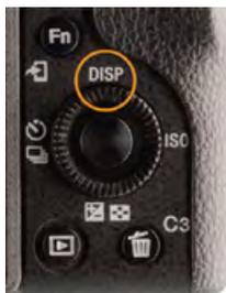
◀ Durch Drücken der DISP-Taste wechseln Sie zwischen verschiedenen Monitoransichten.
