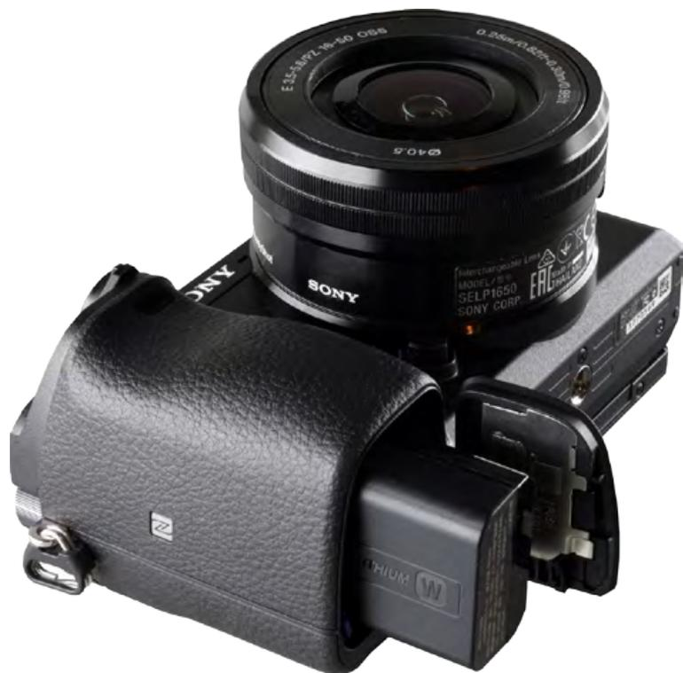
▲ Schieben Sie den Akku mit dem Pfeil in Richtung Kameraußenseite in das Akkufach.
