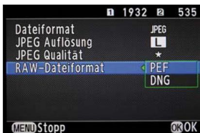
Beim RAW-Format können Sie zwischen zwei Speicherformaten wählen: dem Pentax-eigenen PEF-Format oder dem etwas weiter verbreiteten DNG-Format.
