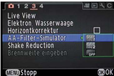
Da die Pentax K-3 keinen eingebauten Tiefpassfilter hat, lassen sich Moirés elektronisch reduzieren.
