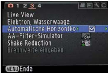
Minimale Abweichungen zur perfekt waagerechten Kamerahaltung lassen sich durch die automatische *Horizontkorrektur* ausgleichen.
