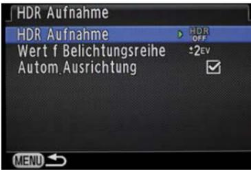
Unter dem Menüpunkt *HDR Aufnahme* können drei Einstellungen verändert werden: die HDR-Art, der Wert für die Belichtungsreihe und die automatische Ausrichtung der Aufnahmen.
