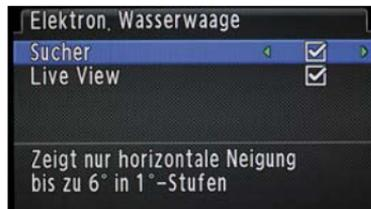
Die elektronische Wasserwaage kann sowohl für den Sucher als auch in der Live-View-Funktion eingeschaltet werden.
