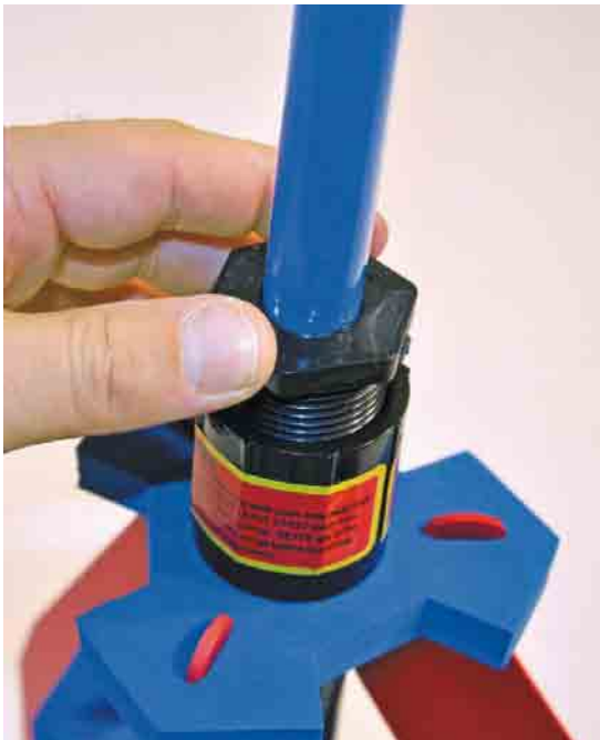
Bild 12.14 – Erst jetzt ist die Startröhre aufzuschrauben.
