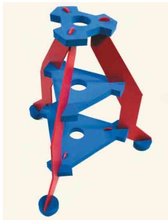
Bild 12.3 – Die Startrampe besteht aus drei Schaumstoffplatten und drei Abstandhaltern. Die Konstruktion ist unerwartet stabil.
