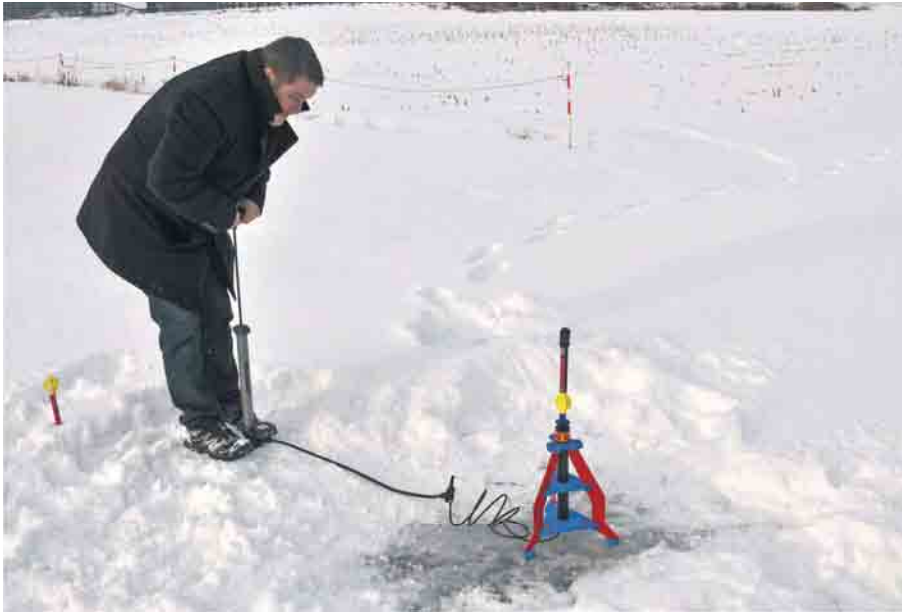
Bild 12.22 – Der Start der Lufrakete wird einzig davon bestimmt, wann der erforderliche Luftdruck im unteren Startzylinder erreicht wird.
