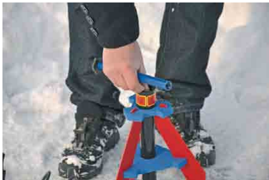
Bild 12.30 – Zuerst ist das Membranplättchen, anschließend die Dichtung einzulegen. Zuletzt ist das Startrohr fest aufzuschrauben.
