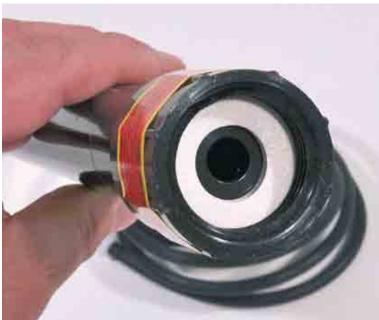
Bild 12.5 – Am oberen Ende sind eine oder mehrere Membranen einzulegen.
