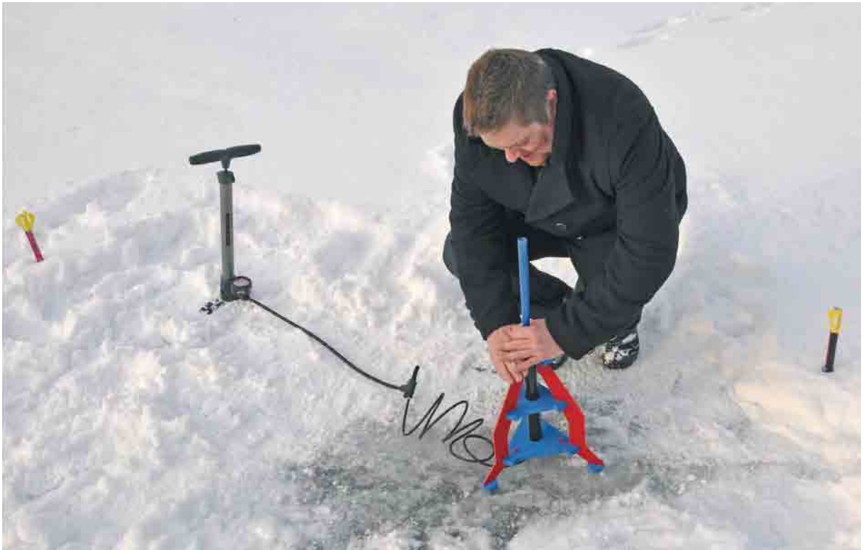
Bild 12.17 – Die Startrampe ist auf waagrechten Untergrund aufzustellen, sodass der Raketenstart senkrecht erfolgt.
