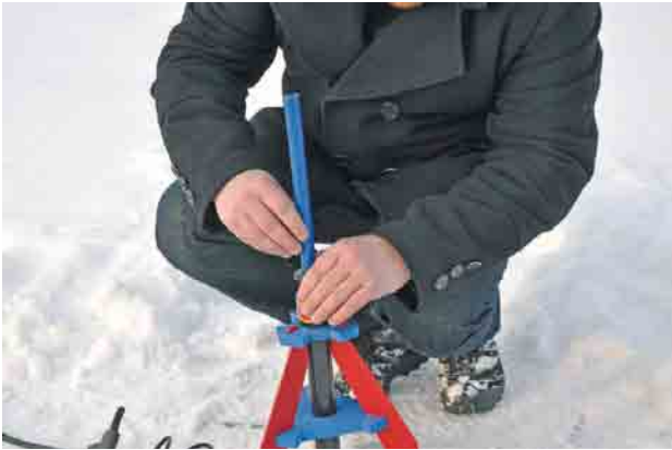
Bild 12.20 – ... ist das obere Startrohr fest anzuschrauben. Andernfalls weicht Luft aus und der zum Start erforderliche Druck kann im Zylinder nicht aufgebaut werden.
