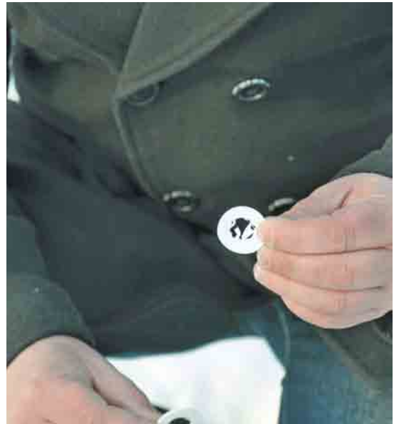
Bild 12.23 – Mit Platzen des Membranplättchens wird die Druckluft freigesetzt. Er weicht nach oben aus und katapultiert die Rakete durch das Startrohr in die Höhe. Die Abbildung zeigt ein wieder ausgebautes Membranplättchen.
