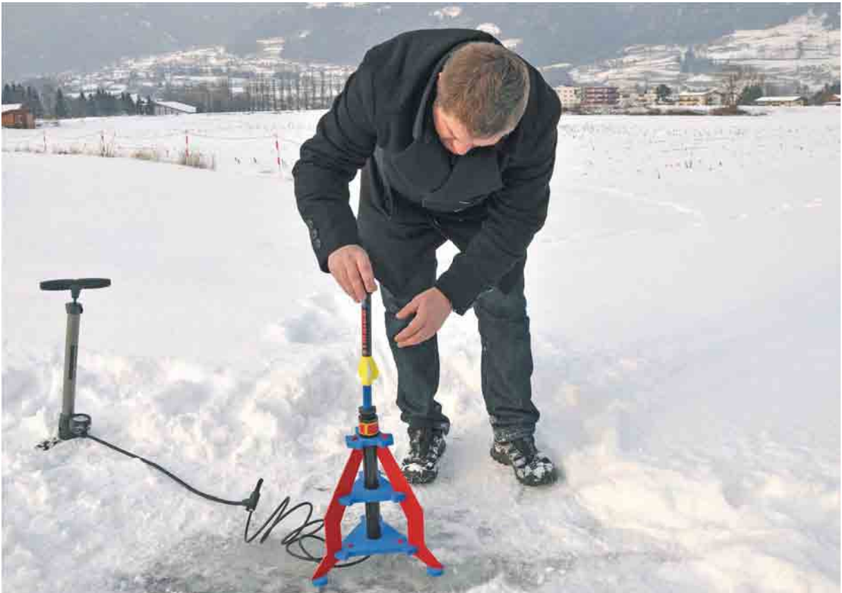
Bild 12.21 – Die Rakete ist so auf das Startrohr zu stecken, dass sie leichtgängig bewegt werden kann. Würde sie feststecken, wäre ein Fehlstart unausweichlich.
