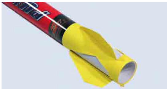
Bild 12.11 – An der Rückseite sind drei Flossen zur Flugstabilisierung angebracht.
