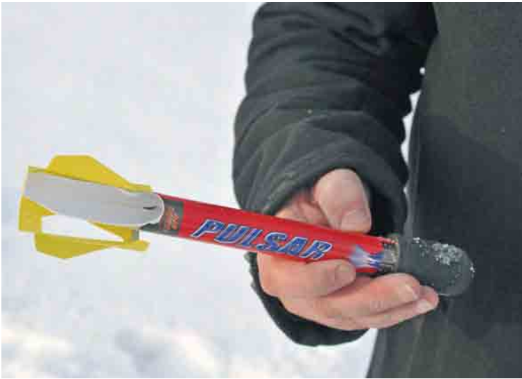
Bild 12.32 – Extreme Kälte oder ein Klemmen am Startrohr kann zur Zerstörung der Luftrakete führen.
