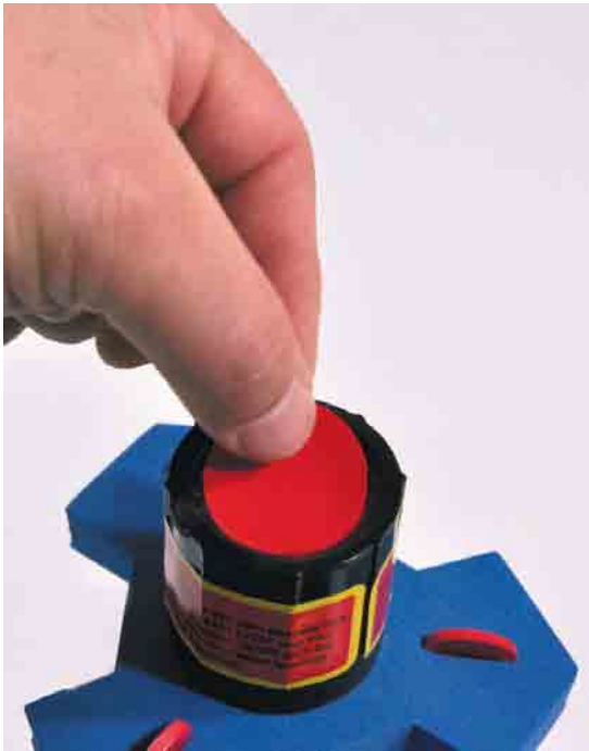
Bild 12.13 – Ins obere Ende des Druckzylinders ist eine Membran zu legen.
