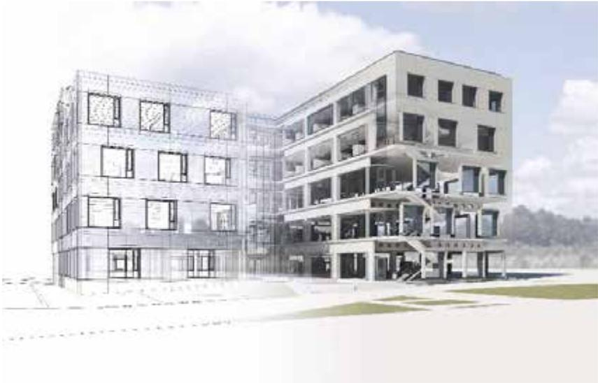
Abb. 1: Digitales BIM-Modell als Basis aller Leistungsphasen bis in den Betrieb eines Gebäudes
