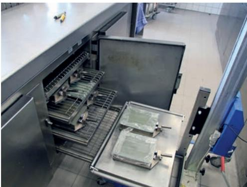
Bild 1.5: Anschließend wird die Stahlform für zwei Tage in der Klimakammer gelagert.
