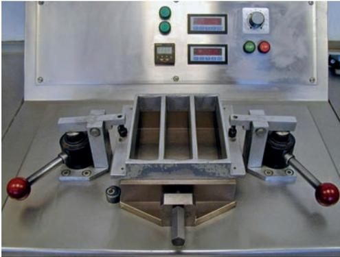
Bild 1.1: Stahlform für die Herstellung von drei Prüfkörpern
