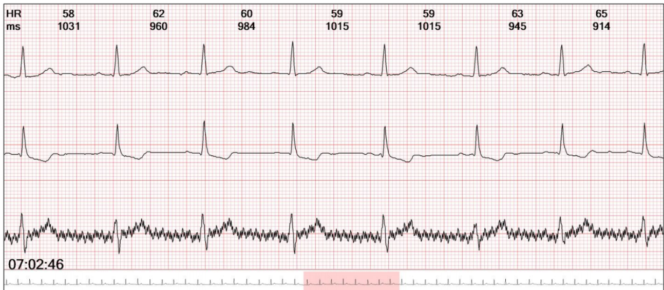
Abbildung 6: Starke Verzitterung im 3. Kanal durch defekte Kabel
