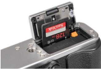
▲ Einlegen von Akku und Speicherkarte.
