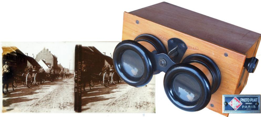
**Bild 2.6** Glasdia aus dem Ersten Weltkrieg mit fokussierbarem Linsenstereoskop von Photo-Plait (Paris)
