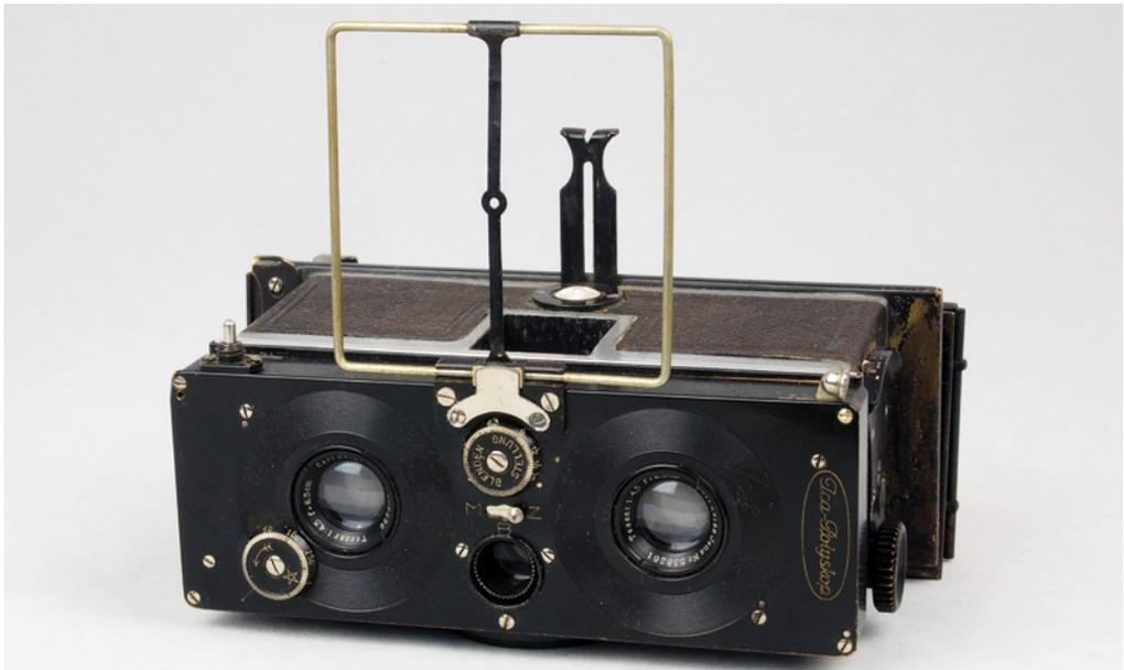
**Bild 2.9** Ica Polyskop um 1920 mit Kassette für Filmpacks
