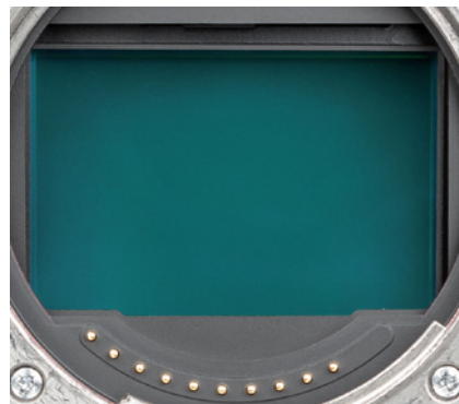
▲ Vollformatsensor der \alpha 7 III (35,6 × 23,8 mm, 24,2 Megapixel).
