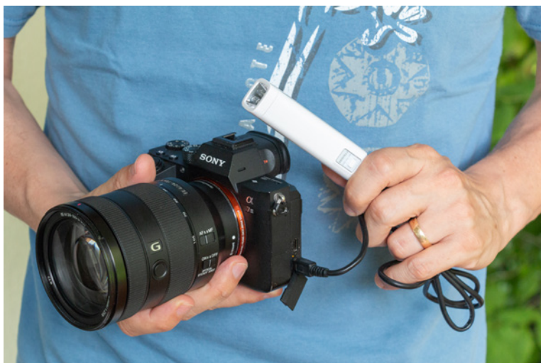
▲ Das Akkupack (hier iconBIT FTB2600LED) liefert Strom via USB an den in der \alpha 7 III eingelegten Akku. Die Ladekontrollleuchte zeigt dies an.
