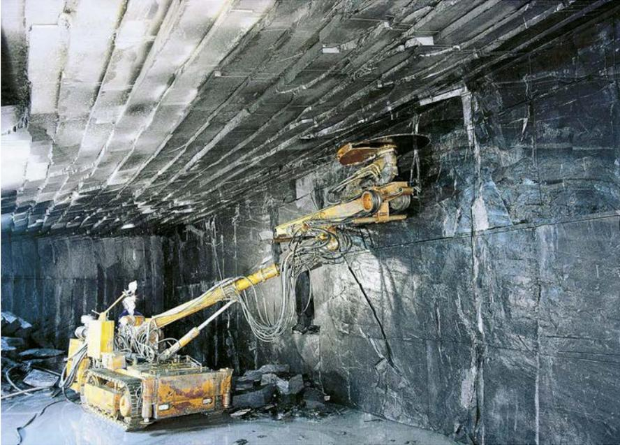
**Abb. 1.3:** Die Schieferblöcke werden geschossweise mit hydraulisch gesteuerten Steinsägen in Blöcken aus dem Lager herausgeschnitten.
