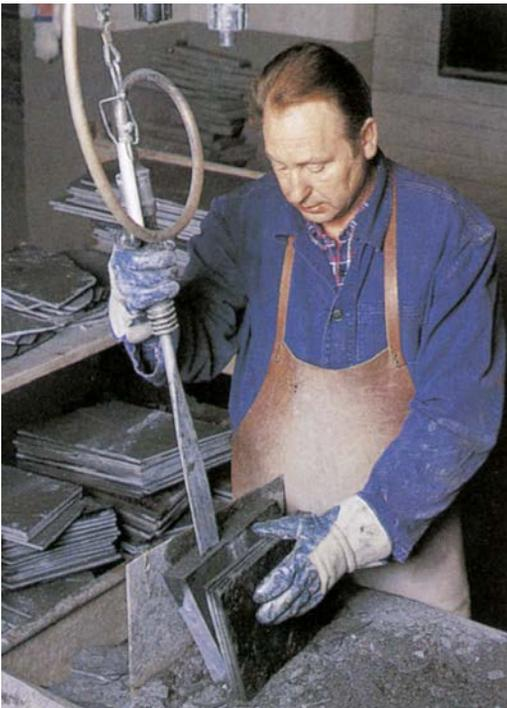
**Abb. 1.4:** Im werkfeuchten Zustand trennt der Spalter die gesägten Schieferblöcke in 4 bis 6 mm dicke Platten.
