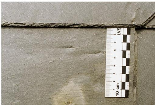
**Abb. 1.8, 1.9 und 1.10:** Dachschiefer mit Schwefelkristallen und erhöhtem Kalkgehalt wäscht in gelblich weißen Flecken aus, die Schwefelkristalle wittern heraus und hinterlassen Löcher.
