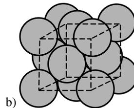
**Bild 1.1-10** Kubisch-flächenzentriertes Gitter (kfz)
