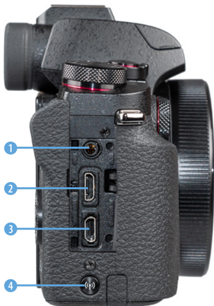
▲ Anschlüsse auf der rechten Seite der G1 X Mark III.
