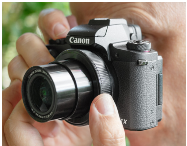
▲ Mit der Ringsteuerung lässt sich standardmäßig zoomen oder der Manuelle Fokus einstellen.
