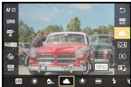
▲ Schnelleinstellung des Weißabgleichs. Mit dem vorderen Wahlrad oder der MENU-Taste sind weitere Einstellungsmöglichkeiten aufrufbar.
