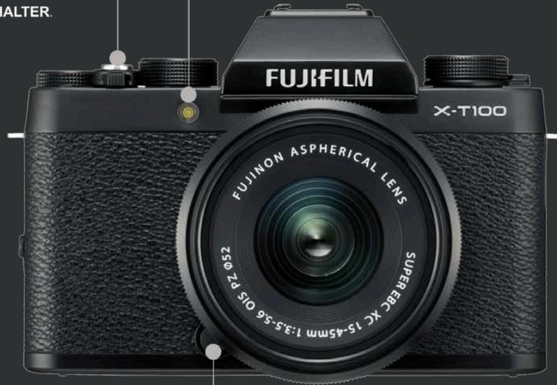
Das **FUNKTIONSWÄHLRAD** kann mit einer individuellen Funktion belegt werden.
