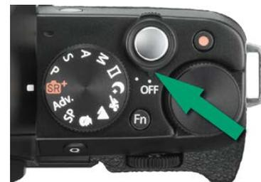
▲ Mit dem hervorgehobenen Schalter schalten Sie die Kamera ein oder aus.
