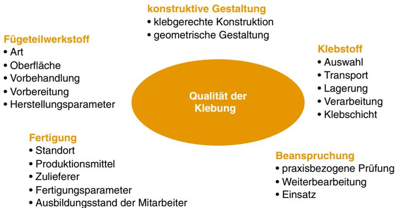
**Bild 2.1** Einflussfaktoren auf die Qualität bzw. Festigkeit einer Klebung
