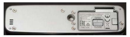
▲ Auf der Unterseite der Kamera befindet sich das Fach für den Akku und die Speicherkarte. Außerdem sehen Sie links den eingebauten Lautsprecher. Decken Sie ihn nicht ab, wenn Sie den O-Ton Ihrer Filmaufnahmen deutlich hörbar wiedergeben möchten.
