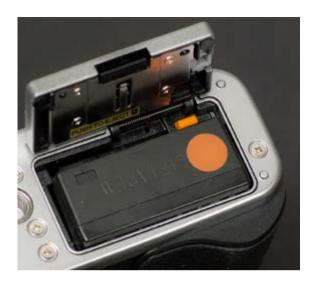
■ Auf der Kameraunterseite befindet sich der Einschub für den Akku. Schieben Sie den Entriegelungshebel in Position OPEN, sodass sich die Klappe öffnet, und setzen Sie den Akku wie abgebildet ein. Leider deckt das Stativgewinde bei Verwendung eines Standardstativadapters den Deckel des Akkufachs ab.
