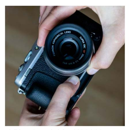
▲ Die Objektiventriegelungstaste wird mit dem Daumen der linken Hand gedrückt.
