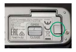
◀ Unter einer kleinen Abdeckung versteckt, findet sich der Durchlass für das Anschlusskabel des Gleichstromkupplers CP-W126.
