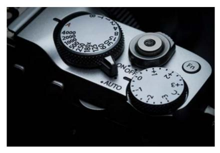
▲ Vorbildlich und an anderen Kameramodellen eher selten zu finden ist die Möglichkeit zum Anschluss eines mechanischen Drahtauslösers direkt am Gewinde des Auslösers.
