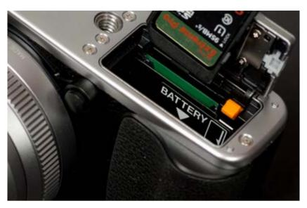
▲ Um die Karte zu entnehmen, schalten Sie die Kamera aus und drücken vorsichtig mit dem Finger auf den mittleren Bereich der Karte, um sie langsam freizugeben. So verhindern Sie, dass die Karte durch Federeinwirkung aus dem Fach herausspringt.
