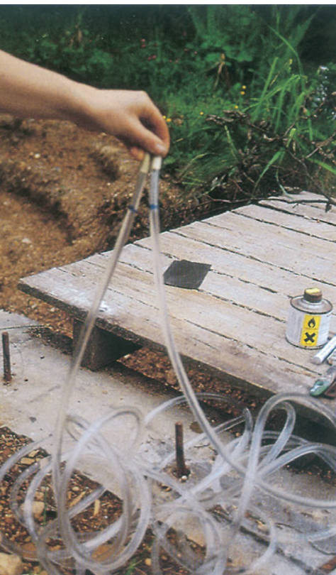
Eine Schlauchwaage ist mit einfachen Mitteln selbst herzustellen.
