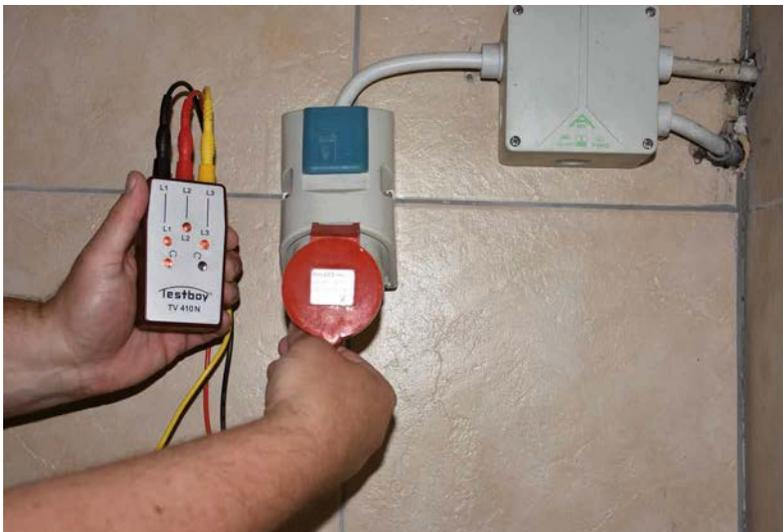
Bei dieser Messung wurde Linkslauf festgestellt. Die Drehrichtung ist also zu ändern.
