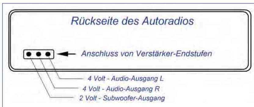
Abb. 1.2 – Der Anschluss zusätzlicher Endstufen erfolgt an der Rückseite des Autoradios an Ausgängen, die in den Unterlagen z. B. als Vorverstärker-Ausgangsspannung 4 V oder Woofer-Ausgang 2 V bezeichnet werden oder zeichnerisch dargestellt sind.
