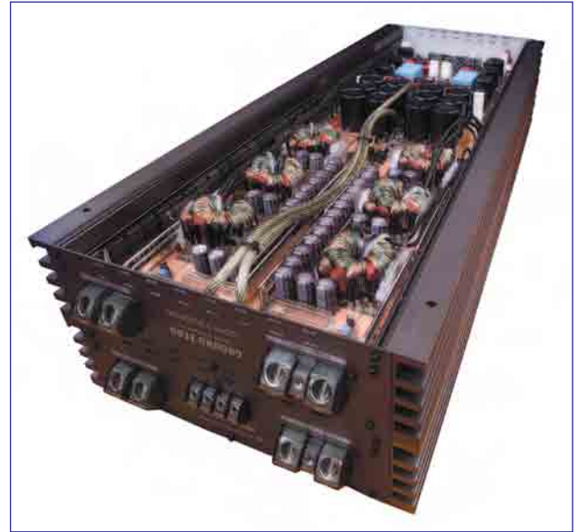
Abb. 3.7 – Der GZPA 2.20000SPL der Ground-Zero GmbH ist innen eine echte Augenweide, aber seine Leistung könnte so manche zu schwach dimensionierte Lautsprecherboxen das Fürchten lehren: Dieser Einkanalverstärker hat eine stolze Leistung 22.000 Watt RMS und ist somit einer der stärksten Car-Verstärker der Welt.
