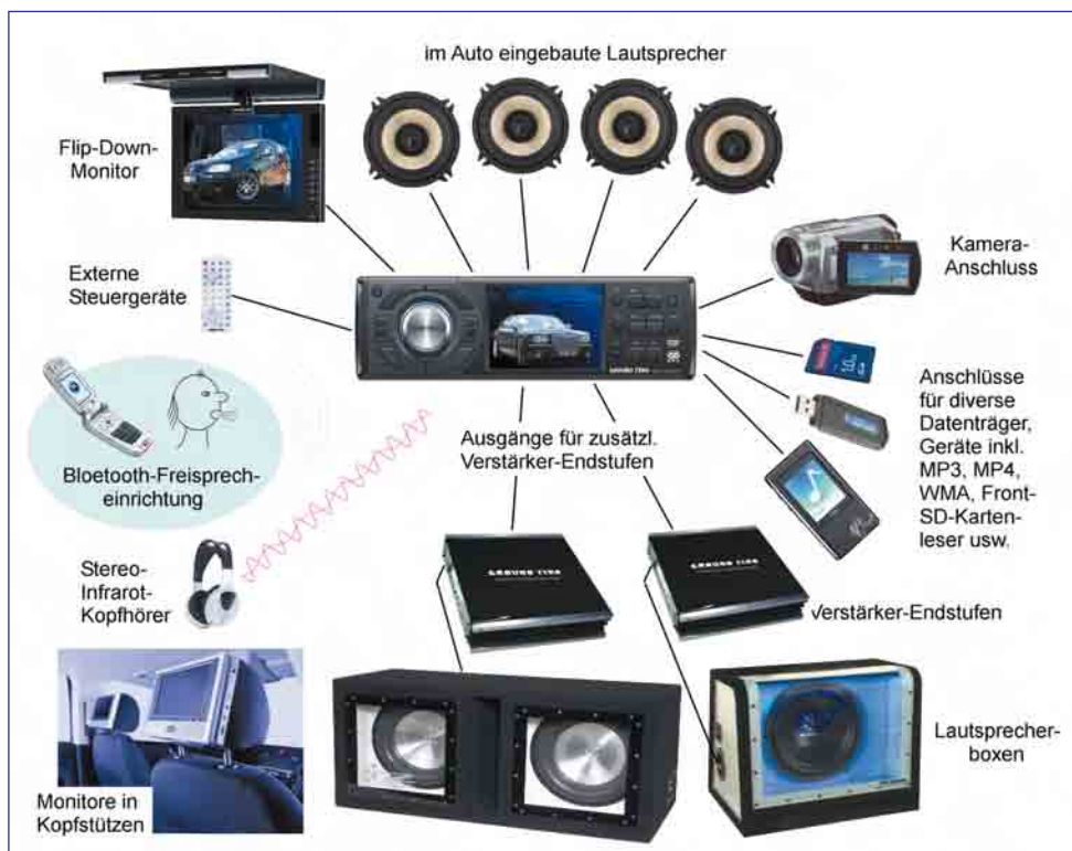
Abb. 1.5 – In ein modernes Steuergerät oder einen Bordcomputer ist zwar ein Radioempfänger integriert, aber der größte Teil der Elektronik bewältigt meist noch sehr viele andere, oft anspruchsvolle Aufgaben.
