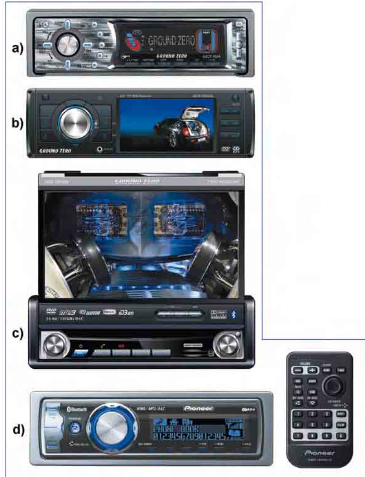
Abb. 1.1 – Da kann das „gute alte“ Autoradio vor Neid erblassen: a) Auch einfachere Autoradios verfügen gegenwärtig zumindest über einen integrierten CD-/MP3-Receiver; b) komfortablere Autoradios, die als Multimedia-Geräte bezeichnet werden, verfügen über einen kleinen eingebauten Monitor und viele Features wie DVD, DVD-R, DVD-RW, MP3, MP4, CD, CD-R, CR-RW, WMA, USB u. ä. c) die aufwendigsten Multimedia-Geräte bieten ausfahrbare Touchscreen-Monitore, eine Bluetooth-Freisprecheinrichtung, Dolby-Digital-Sound und natürlich alle Features, die zuvor aufgelistet wurden d) Pioneer-Autoradio mit Fernbedienung (Fotos/Anbieter: Ground Zero GmbH).
