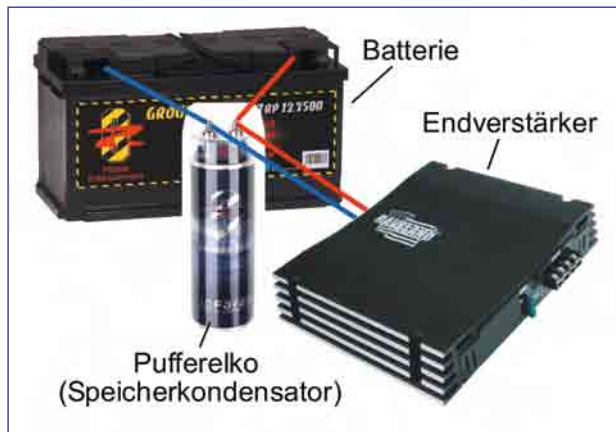
Abb. 9.11 – Ein zusätzlicher Speicherkondensator (Pufferelko) fängt gelegentliche Leistungsspitzen ab, die bei abrupt auftretenden lauten Klangimpulsen entstehen.
