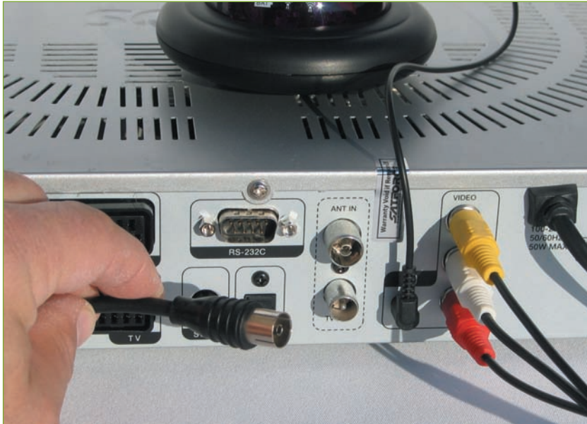
Abb. 11.6 – Über die untere Antennenbuchse lassen sich weitere Fernseher an den Multiroom-Receiver anschließen.
