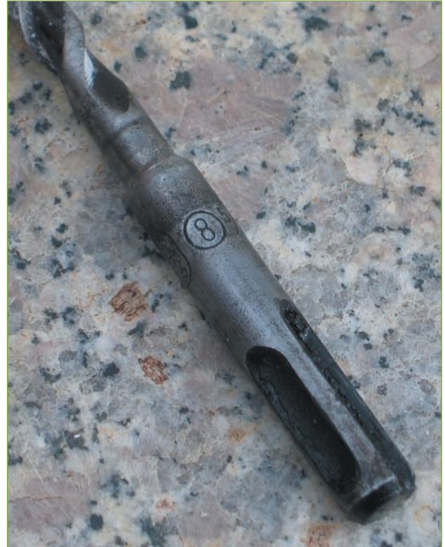
Abb. 5.11 – Die Größe eines Steinbohrers lässt sich am Schaft nachlesen. Im Bild: ein 8er-Bohrer.
