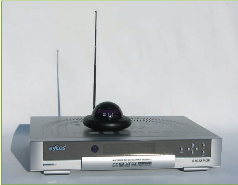
Abb. 11.4 – Dieses Gerät empfängt die Steuerbefehle der zweiten Fernbedienung über einen UHF-Empfänger. Auf dem Gehäusedeckel steht die erforderliche Antenne.
