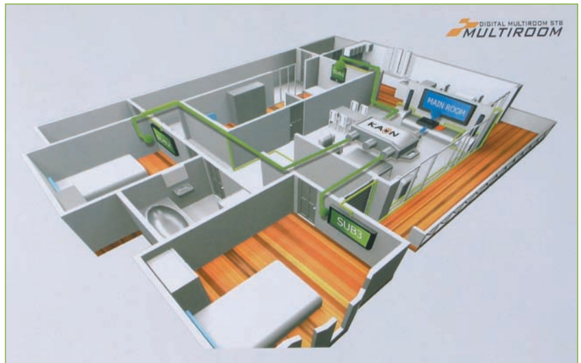
Abb. 11.2 – Ein Receiver, vier Fernseher. Verdrahtungsbeispiel für einen Multiroom-Receiver. (Bild: Kaon)
