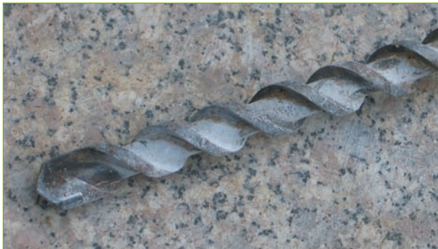
Abb. 5.10 – Steinbohrer erkennt man an ihrem groben Gewinde.
