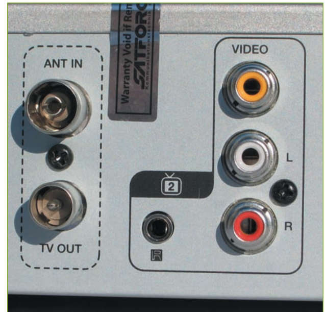
Abb. 11.5 – Auf der Geräterückseite erkennt man manchmal erst bei genauerem Hinsehen den zweiten Cinch-AV-Ausgang, an den der zweite Fernseher anzuschließen ist.
