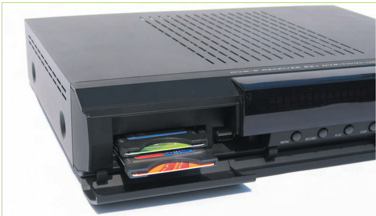
Abb. 1.6 – Nur wenn in einen digitalen Satellitenreceiver mindestens eine CI-Schnittstelle eingebaut ist, lässt er sich bei Bedarf für fast jedes Verschlüsselungssystem erweitern.
