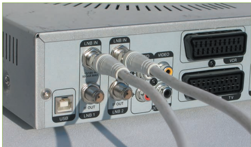
Abb. 11.7 – Damit in zwei Räumen Fernsehprogramme unabhängig voneinander nutzbar sind, sind an den Sat-Antennen-Anschlüssen des Receivers zwei LNBs anzuschließen.
