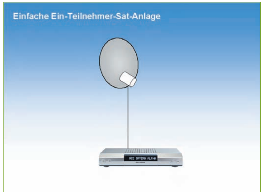
Abb. 1.8 – Einteilnehmer-Anlagen erlauben nur den Anschluss eines Sat-Receiver und eignen sich für den Wohnwagen oder das Wochenendhaus.
