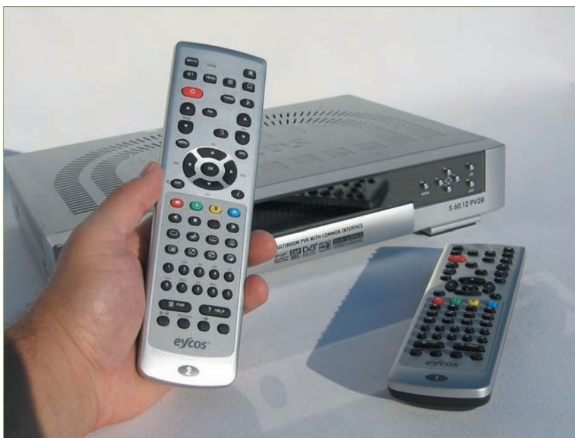
Abb. 11.3 – Multiroom-Satellitenreceiver arbeiten mit zwei Fernbedienungen. Jede steuert einen der beiden eingebauten Digitalreceiver.
