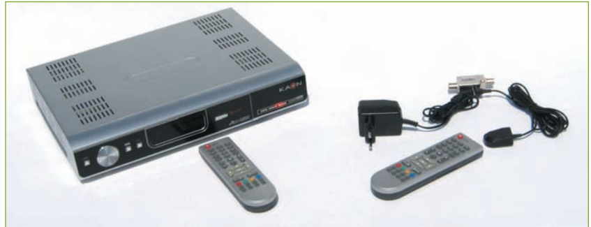
Abb. 11.1 – Multiroom-Receiver von Kaon. Die zweite Fernbedienung ist für ein zweites TV-Gerät vorgesehen. Die Steuerung erfolgt über das zu ihm zu verlegende Antennenkabel und einem Adapter, an dem ein separater Fernbedienungsempfänger angeschlossen wird.
