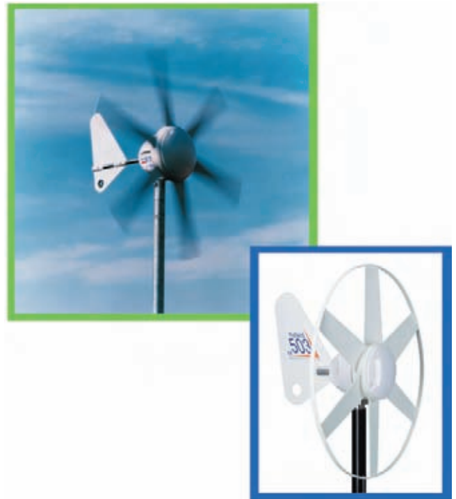
Abb. 77 – Ein „Propeller-Windgenerator“ (Schnellläufer) eignet sich nur für Gebiete mit hohen Windstärken: zwei Ausführungsbeispiele von kleinen handelsüblichen Windgeneratoren (Fotos: Conrad Electronic)
