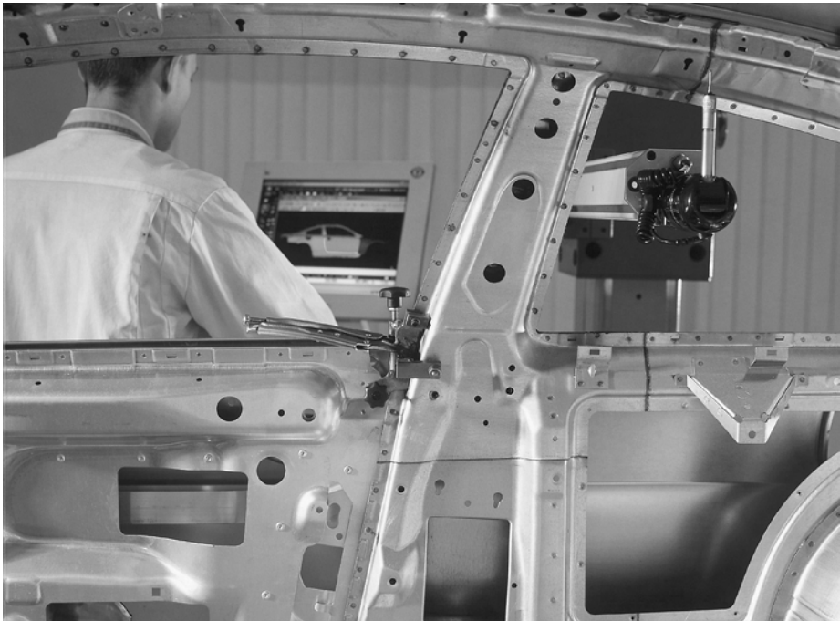
Überprüfung einer Karosserie mit Hilfe einer Videokamera im Analyseraum von BMW
