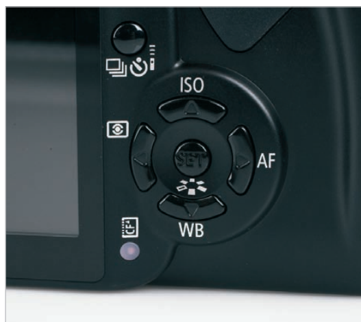
Blinkt die Lampe unter dem CF-Symbol, darf das Kartenfach nicht geöffnet werden, weil die Kamera Bilddaten auf die Speicherkarte schreibt.
