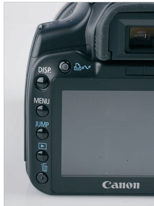
Links neben dem Display befindet sich der MENU -Knopf zum Aktivieren des Kameramenüs.
