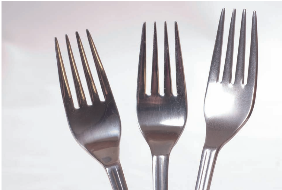
Die mittlere Gabel wurde mit Pflanzenfett dünn eingeschmiert, die rechte mit Mattspray besprüht. Die Zinken der rechten Gabel weisen daher auch die geringsten Reflexionen und keine Spiegelungen auf.
