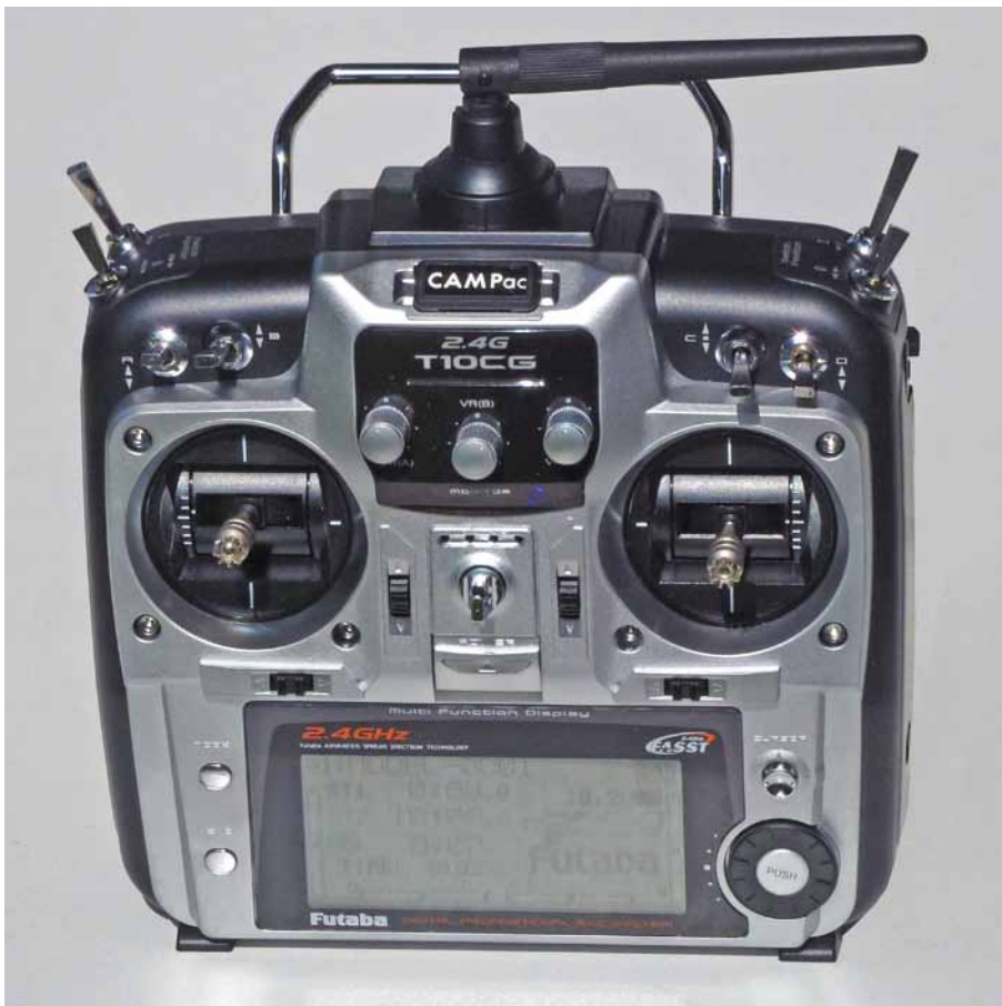
Abb. 12.1 – Im RC-Modellflug kommen RC-Fernsteuerungen mit zwei Steuerknüppeln zum Einsatz. Heute sind programmierbare Fernsteuerungen mit Display allgemein üblich.
