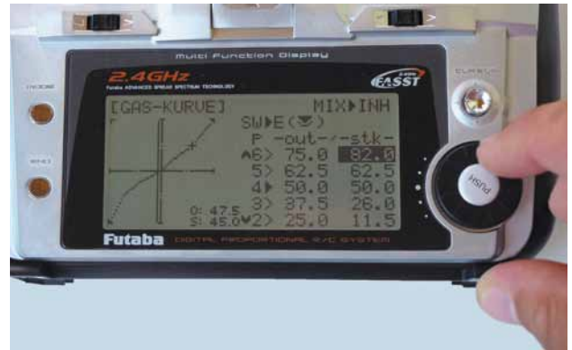
Abb. 12.4 – Auch so kann eine Gaskurve verlaufen. Bei dieser gerade vorgenommenen Programmierung wird Wert auf eine sensible Steuerung im Mittelgasbereich gelegt.
