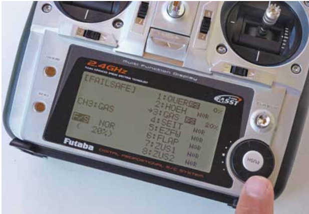
Abb. 12.6 – Im Failsave-Menü kann eine Drosselung des Gashebels programmiert werden. Damit wird eine akkuschonende Landung gewährleistet.
