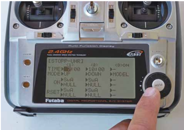
Abb. 12.7 – Ein oder mehrere programmierbare(r) Timer, hier Stoppuhr genannt, helfen, z. B. die Gesamtflugzeit und die Motorlaufzeiten zu überwachen.
