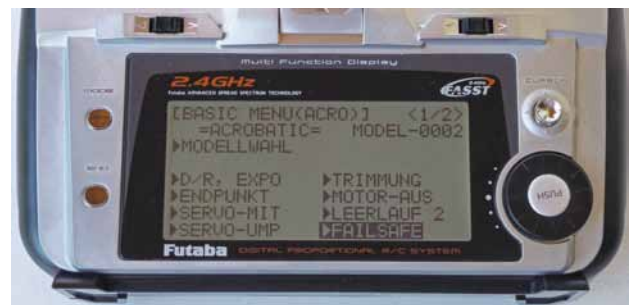
Abb. 12.5 – Zunächst ist im Programmiermenü die Failsave-Funktion auszuwählen.
