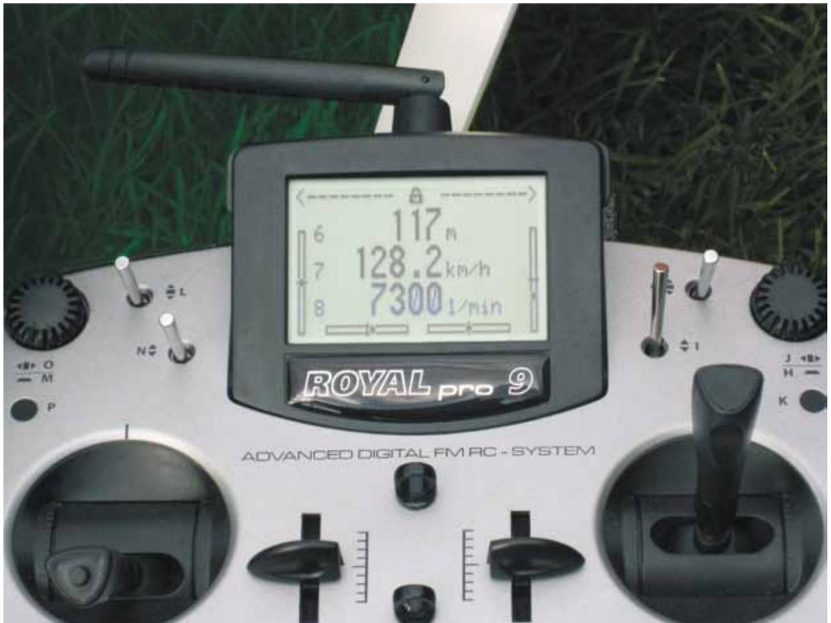
Abb. 1.9: Maximalwerte von Flughöhe, Geschwindigkeit und U/min auf einen Blick (Displaydarstellung)
