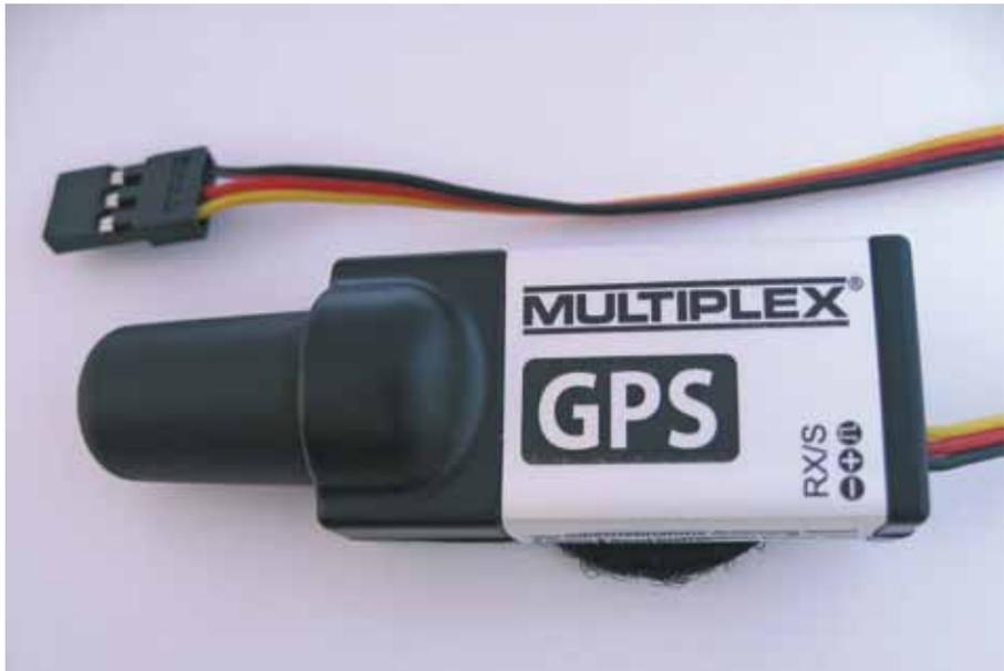
Abb. 1.1: GPS endlich für den Modellflug nutzen: GPS-Sensor
